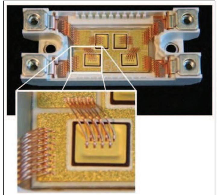
**DBB 400 V/150 A rectifier module**
