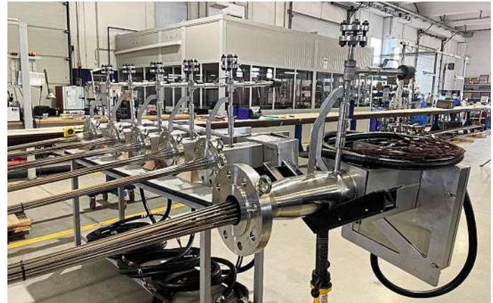
Für den Aufbau eines Temperaturprofils in Katalysatorbetten kommen vor allem Thermoelemente mit einer Mehrzahl flexibel positionierbarer Sensoren in Frage, wie beispielsweise Typ TC96 FlexR.
