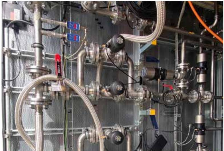
Prozessarmaturen notwendig. Wasserstoffanwendungen sind hier allerdings anspruchsvoll, denn das Wasserstoffatom hat die kleinste Masse und ist daher sehr flüchtig. Da Wasserstoff zudem ein brennbares und potenziell explosives Gas ist, müssen alle Komponenten, die damit in Berührung kommen, hohe Dichtheitsanforderungen erfüllen. Obendrein hat er die unangenehme Eigenschaft, in Metalle zu diffundieren und die Werkstoffeigenschaften zu verändern. Versprödungen oder Korrosion können die Folge sein.
