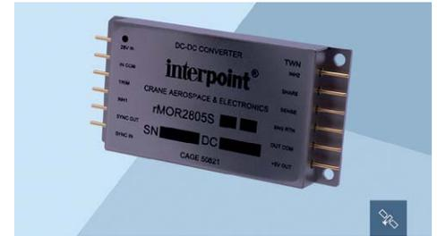
Emissionen. Erhältlich sind die Wandler mit Standard-Screening oder »ES«-Screening. Als Single-Ended-Forward-Wandler arbeiten die Wandler der rMOR-Serie mit synchroner Gleichrichtung. Sie benutzen Pulsweitenmodulation und eine konstante Schaltfrequenz von 500 kHz. (eg)
