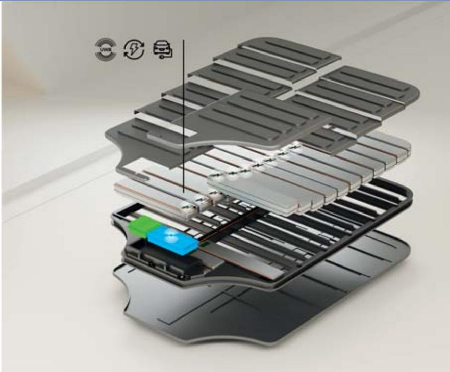
Wenn es um kabellose Technologien für Batteriemanagementsysteme geht, sind nicht alle Optionen gleich gut. Der Einsatz von Ultrabreitband (UWB) bietet hierbei wichtige Vorteile gegenüber anderen drahtlosen Technologien, wie schmalbandige 2,4 GHz Funkssysteme (z. B. Bluetooth Low Energy). Bild: NXP
