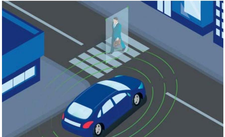
Die automatische Notbremsung vor Fußgängern an Kreuzungen ist ein Beispiel für eine sicherheitsrelevante Anwendung, die den Einsatz von Kurzstreckenradaren weiter vorantreiben wird.
