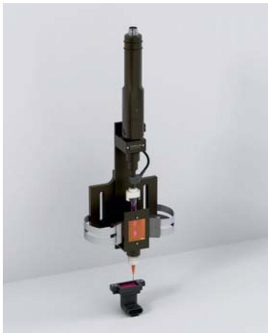
Bild 5: Pinabdichtung via Durchflussaktivierung.
