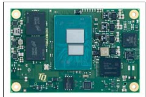
SMARC-Modul TQMxE41S das Portfolio im Bereich kostengünstiger x86-Technologie in Industriequalität. 2,5 GByte Ethernet, schnelle PCIe-x4-Anbindung und 2 x USB 3.2 sind die passenden Schnittstellen des Embedded-Moduls für den High-Speed-Datentransfer. Davon profitieren vor allem Anwendungen im Bereich Datenerfassung: FPGA-Lösungen und externe Peripherie können uneingeschränkt mit geringer
