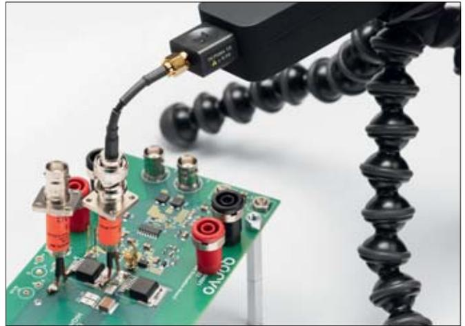
Ein Doppelpuls-Prüfaufbau mit mehreren Tastköpfen, die an die Wandlerstufe angeschlossen sind.
