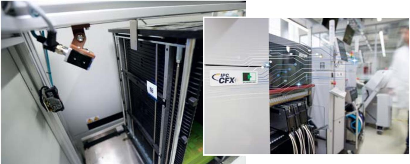
Ein Barcode-Leser ist nur an der ersten Maschine der Linie erforderlich. Die gescannten Daten werden dann von Maschine zu Maschine weitergegeben.
