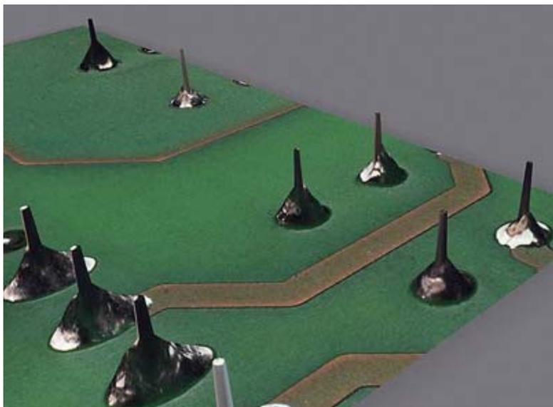
Bild 4: 3D-Aufnahme einer Baugruppe mit Lötfehlern
