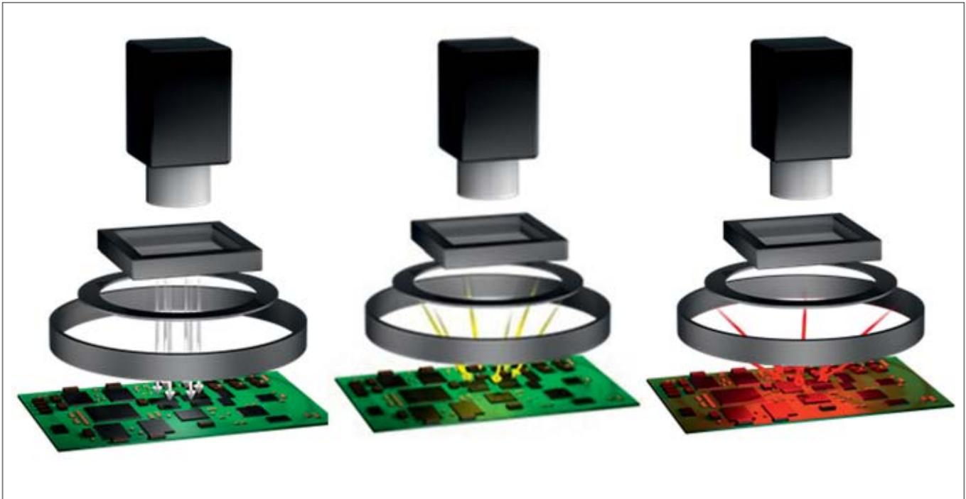
Bild 1: Verschiedene Kamera- und Beleuchtungstechniken. Bild: Göpel electronic
