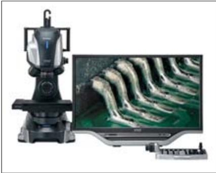
Das Digitalmikroskop VHX-X1 prüft die Qualität von Halbleitern. *Bild: Limtronik*
