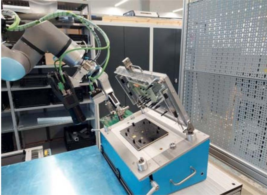
Roboter beim Einsetzen der Baugruppe in den Testadapter
