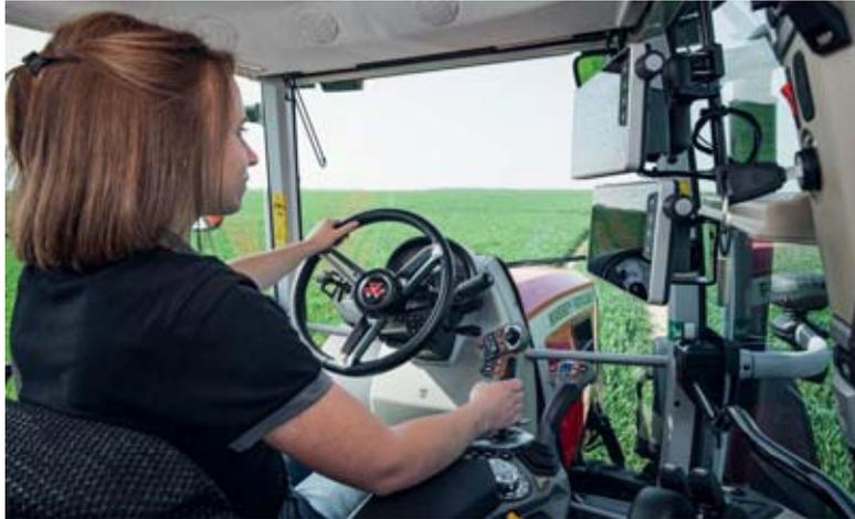
Die multifunktionale Armreststeuerung wurde in zwölf Ausbaustufen für die neueste Traktoren- generation von Massey Ferguson entwickelt. *Bilder: Rafi*
