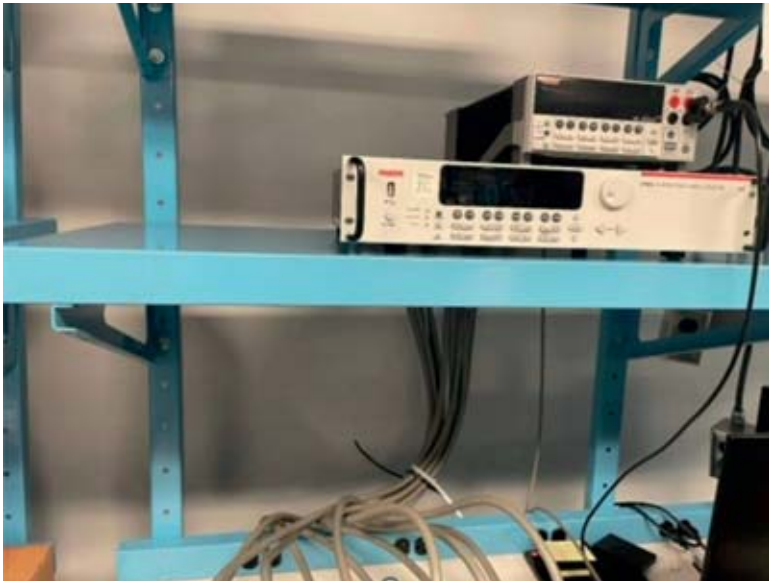
Bild 3: Typischer Laboraufbau für die Durchgangsprüfung der integrierten Schaltung.
