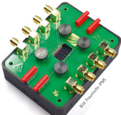
Neuer Messadapter für die gleichzeitige Kontaktierung von bis zu acht Interdigitalelektrodenpaaren.
